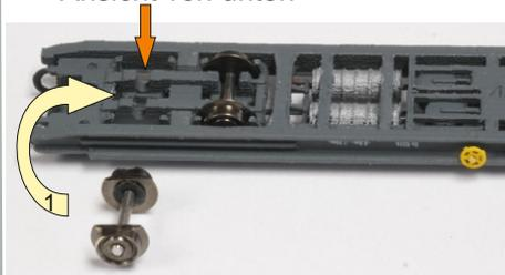
Drücken Sie mit dem Rücken einer Pinzette auf den Radsatz, damit die Schleifflächen parallel zueinander liegen. Mit der Pinzette legen Sie den Radsatz in die Achsmulden (oranger Pfeil) und kleben die Achse vorsichtig mit etwas Klebstoff fest. Lassen Sie den Klebstoff aushärten, bevor Sie weiterarbeiten.
