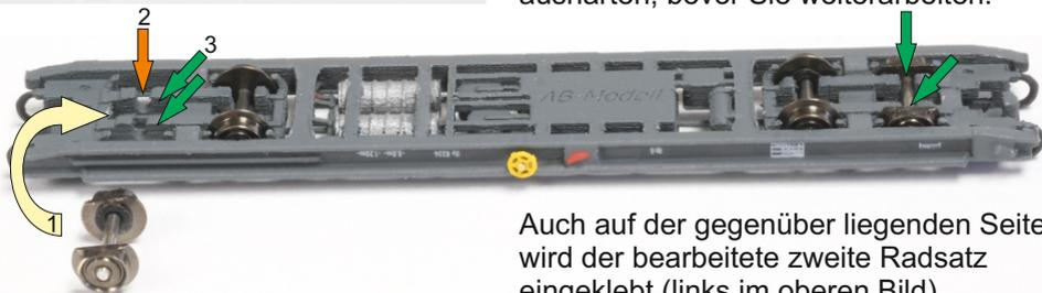
Auch auf der gegenüber liegenden Seite wird der bearbeitete zweite Radsatz eingeklebt (links im oberen Bild).
