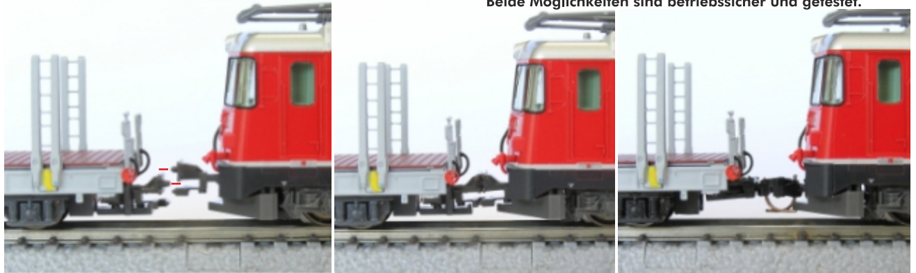
Unterschiedliche Kupplungshöhen anpassen a) durch Wagenkupplung an der Lok b) oder mittels MTL-Kupplungen
