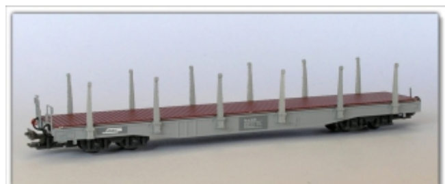
PI-9102.Nm: RhB Sp-w 8280, Rungenwagen mit Einzelrungen, Spur Nm, mit Kato-Kurzkupplung, Pirata-Modell
