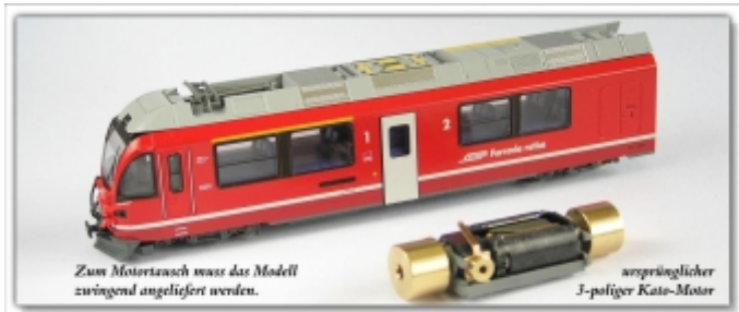
KT-109.1: Motortausch bei RhB ABe8/12 3501, von Original-Kato- auf sb-modellbau Maxon 0816-Motor
