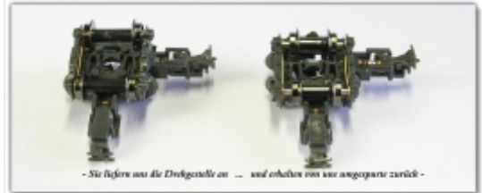
KT-110.2: Umspurung von Kato-Drehgestellen aus dem BEX-Set von 9mm auf 6,5mm, Preis pro ein Drehgestell
