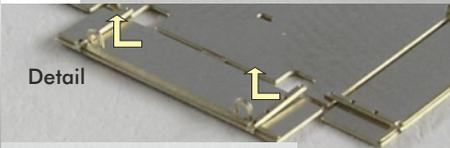
Zum Schluss werden noch die Seitenwände um 90° nach oben gebogen (e). Sie sind so lang, dass die Ecken **nicht** bündig miteinander schließen. Dies ist korrekt und entspricht dem Vorbild!
