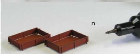
Nach der Lackierung werden die Rahmenstreben des Wagenkastens schwarz abgesetzt. Dazu kann ein spitzer Faserschreiber sehr gute Dienste leisten (Schritt n).
