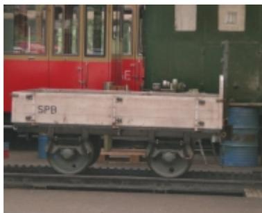
OM°71 im Depotareal in Wilderswil. Er ist mit Aluminiumwänden ausgestattet und trägt die ursprüngliche Fahrzeugnummer 51 auf der Stirnseite.
