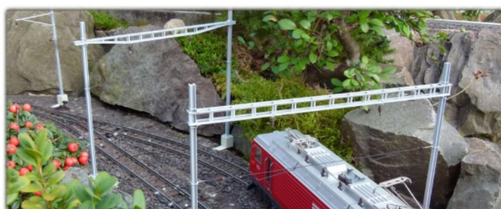
0m-855.12: H-Profil Quertragwerk mit rechteckigem Sockel und Querseil (Bausatz, Neusilber)
