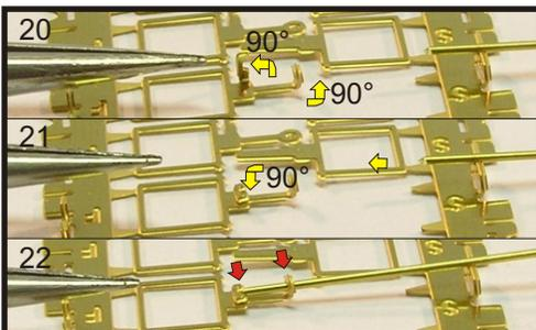
20. Am Fahrleitungshalter F wird die vordere Öse um 90° nach oben gebogen. Auch der Anschlag wird um 90° nach oben gebogen (Ätzlinie liegt außen).
