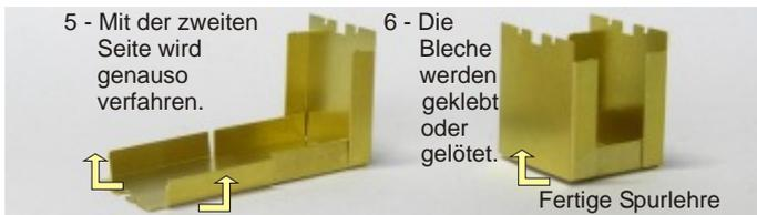
5 - Mit der zweiten Seite wird genauso verfahren.
