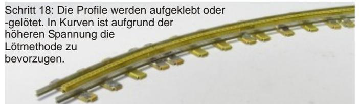
Schritt 18: Die Profile werden aufgeklebt oder -gelötet. In Kurven ist aufgrund der höheren Spannung die Lötmethode zu bevorzugen.
