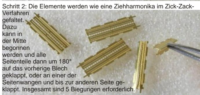
Schritt 2: Die Elemente werden wie eine Ziehharmonika im Zick-Zack-Verfahren gefaltet. Dazu kann in der Mitte begonnen werden und alle Seitenteile dann um 180° auf das vorherige Blech geklappt, oder an einer der Seitenwangen und bis zur anderen Seite geklappt. Insgesamt sind 5 Biegungen erforderlich.
