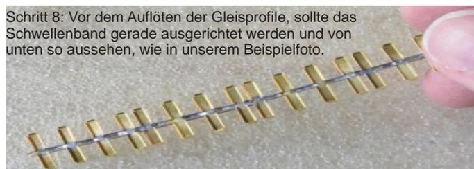
Schritt 8: Vor dem Auflöten der Gleisprofile, sollte das Schwellenband gerade ausgerichtet werden und von unten so aussehen, wie in unserem Beispielfoto.
