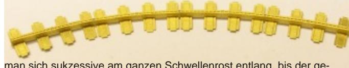
man sich sukzessive am ganzen Schwellenrost entlang, bis der gewünschte Radius erreicht ist. Auf dem Bild ist gut zu erkennen, dass die Schwellen noch nicht in ihre endgültige Form gebogen wurden. So lässt sich die Biegung leichter prüfen und das Rost besser ausrichten.
