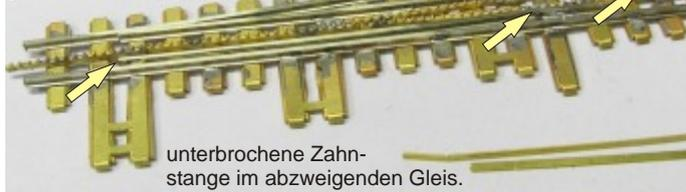
unterbrochene Zahnstange im abzweigenden Gleis.
