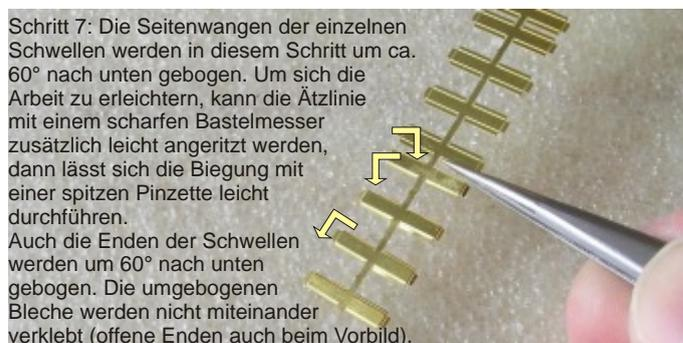
Schritt 7: Die Seitenwangen der einzelnen Schwellen werden in diesem Schritt um ca. 60° nach unten gebogen. Um sich die Arbeit zu erleichtern, kann die Ätzlinie mit einem scharfen Bastelmesser zusätzlich leicht angeritzt werden, dann lässt sich die Biegung mit einer spitzen Pinzette leicht durchführen. Auch die Enden der Schwellen werden um 60° nach unten gebogen. Die umgebogenen Bleche werden nicht miteinander verklebt (offene Enden auch beim Vorbild).
