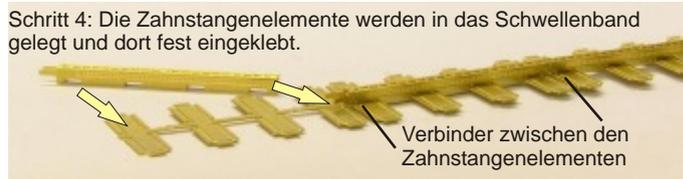
Schritt 4: Die Zahnstangenelemente werden in das Schwellenband gelegt und dort fest eingeklebt.
