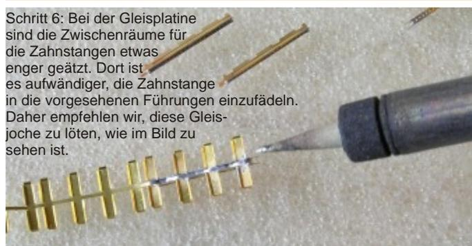
Schritt 6: Bei der Gleisplatine sind die Zwischenräume für die Zahnstangen etwas enger geätzt. Dort ist es aufwändiger, die Zahnstange in die vorgesehenen Führungen einzufädeln. Daher empfehlen wir, diese Gleisjoche zu löten, wie im Bild zu sehen ist.
