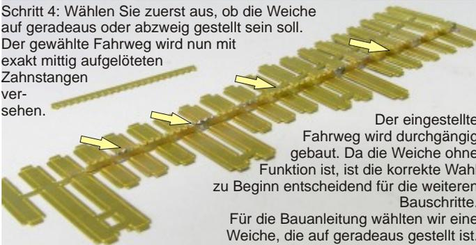
Der eingestellte Fahrweg wird durchgängig gebaut. Da die Weiche ohne Funktion ist, ist die korrekte Wahl zu Beginn entscheidend für die weiteren Bauschritte.
