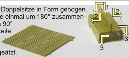
Schritt 11: Die Einzelsitzbänke werden nach gleichem Schema gebogen, wobei der zweite Teil der Bank durch zwei Stützen ersetzt ist. Die Sitzbänke einsetzen und festkleben. Die nach unten hervortretenden Führungsnasen werden weggeschliffen.
