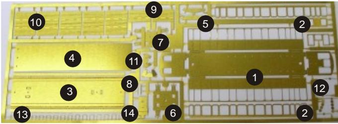
**Bauteile:** 4 - Dach 8 - Handbremse 12 - Leuchte
