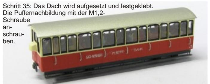
Schritt 35: Das Dach wird aufgesetzt und festgeklebt. Die Puffernachbildung mit der M1,2-Schraube anschrauben.
