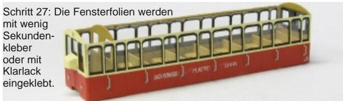
Schritt 27: Die Fensterfolien werden mit wenig Sekundenkleber oder mit Klarlack eingeklebt.
