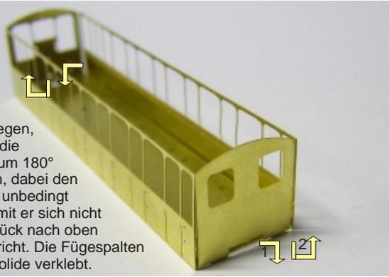
So sieht das Gehäuse aus der anderen Perspektive aus, wenn es fertig gebogen ist. Die Pfeile markieren die Stellen, an denen das Gehäuse geklebt werden soll.
