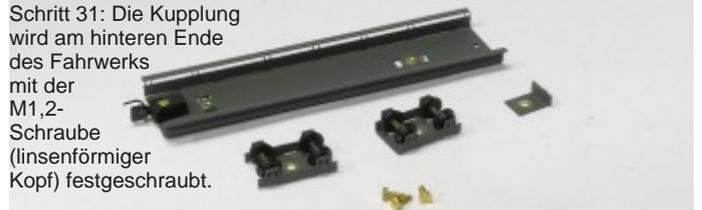
Schritt 31: Die Kupplung wird am hinteren Ende des Fahrwerks mit der M1,2-Schraube (linsenförmiger Kopf) festgeschraubt.
