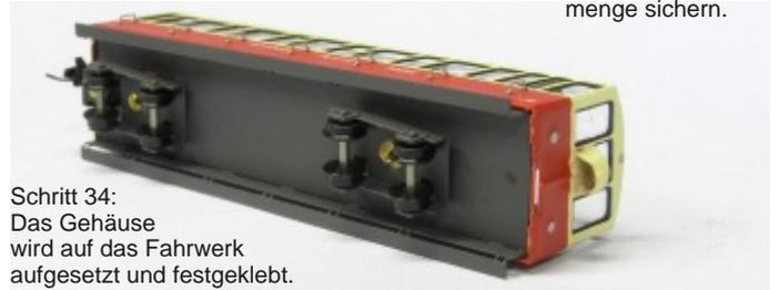
Schritt 34: Das Gehäuse wird auf das Fahrwerk aufgesetzt und festgeklebt.
