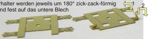
Detailansicht des zu biegenden Achslagers. Die Pfeile geben jeweils die Stelle an, an der das Bauteil um 180° auf das darunter liegende Blech geklappt wird.
