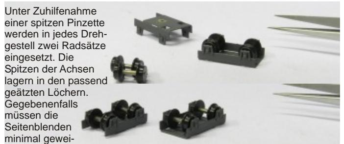
Unter Zuhilfenahme einer spitzen Pinzette werden in jedes Drehgestell zwei Radsätze eingesetzt. Die Spitzen der Achsen lagern in den passend geätzten Löchern. Gegebenenfalls müssen die Seitenblenden minimal geweitet werden.
