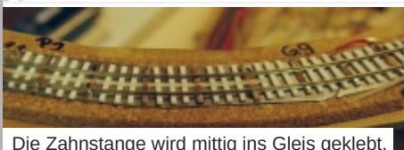
Die Zahnstange wird mittig ins Gleis geklebt.
