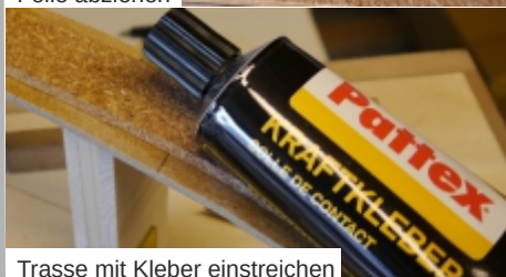
Trasse mit Kleber einstreichen
