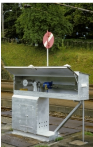
Gleiswaage an der regelspurigen Schweizer Bundesbahn (Bahnhof Meggen, 1986) Foto: Ulrich Neumann / Slg. Peter Hürzeler
