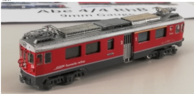
Ein attraktives Vorbild, mittels 3D-Drucktechnik umgesetzt und mit Ätzteilen verfeinert: der ABe4/4 53.
