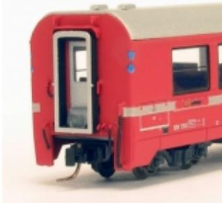
Der Niederflursteuerwagen ist in Kooperation mit einem österreichischen Modellbahner entstanden, der das Fahrzeug ursprünglich als 3D-gedrucktes Modell konstruiert hat. Unserer Modellphilosophie folgend, haben wir die Konstruktion auf ein geätztes Neusilbergehäuse geändert,
