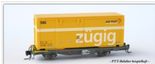
Nm-013.2: RhB Lb-v 7861, Tragwagen mit PTT-Wechselbehälter Creanorm (Kunststoff), Metallmodell für Nm (6,5mm)
