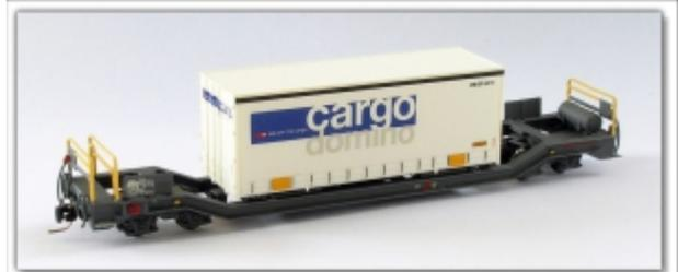
**Nm-019.3:** RhB Sbk-v 7701, Tragwagen mit cargo domino-Wechselbehälter (Kunststoff, Fleischmann), für Nm (6,5mm)
