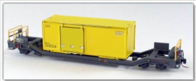
**Nm-019.1:** RhB Sbk-v 7701, Tragwagen mit PTT-Wechselbehälter (Messing, Lokschlosserei), Metallmodell Nm (6,5mm)
