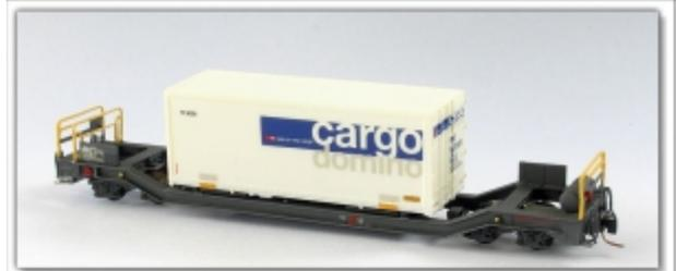
**Nm-019.4:** RhB Sbk-v 7701, Tragwagen mit cargo domino-Wechselkoffer (Kunststoff, Fleischmann), für Nm (6,5mm)
