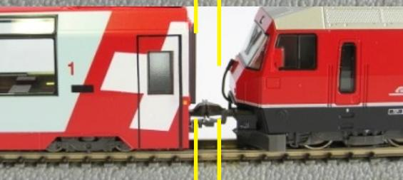
Nochmals engerer Kupplungsabstand bei Verwendung der MTL-Kupplung (oben) im Vergleich zur Kato Kurzkupplung Typ Scharfenberg (unten).
